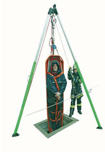
Fig. 2. Tripode EN 795 | EN 1496 | CE 0158 Altezza nominale 3,20 diametro 2,26 m Diffusione di carico m Materiale di trasporto 300 kg di carico Persona di trasporto 2 trasporto persone di peso 30 kg Dimensioni imballo L = 2.00 m D= 0.40 m PRODUTTORE bornack http://www.bornack.de
