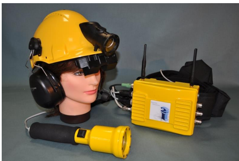
Fig. 27 Esempio di sistema di comunicazione bidirezionale audio e video che consente, ad esempio, di tenere in contatto l'operatore all'interno dell'ambiente confinato e un operatore esterno. L'immagine mostra un sistema dotato due sistemi di acquisizione di immagini, uno sul casco l'atro brandeggiabile con funzioni anche di torcia. Contemporaneamente il casco è dotato di un visore/schermo che permette in remoto di interagire in diretta con l'operatore su ciò che vede. Il tutto completato da un sistema audio di comunicazione PRODUTTORE 12 INDUSTRIAL INNOVATION PRODUTTORE http://www.industrial-innovation.it/
