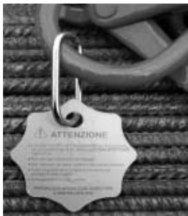
◀ Campanella con targhetta di identificazione che deve essere leggibile.
