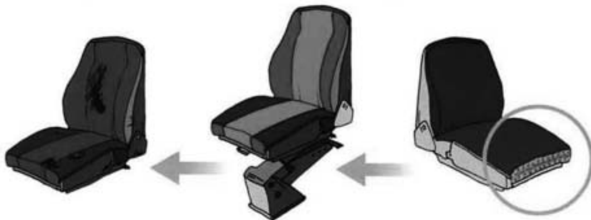
Sedile antiquato senza soluzioni antivibrazione
