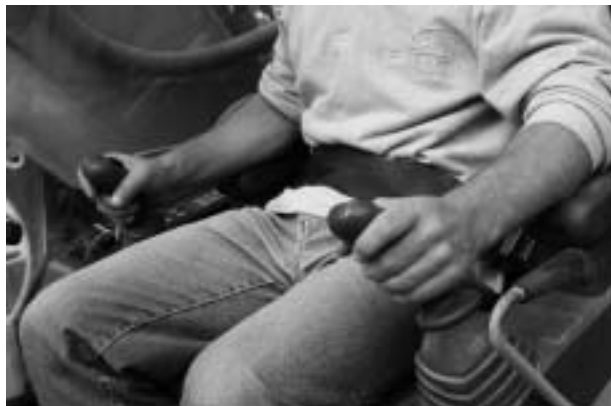
Operatore alla guida di escavatore vincolato al sedile con regolare cintura di sicurezza
