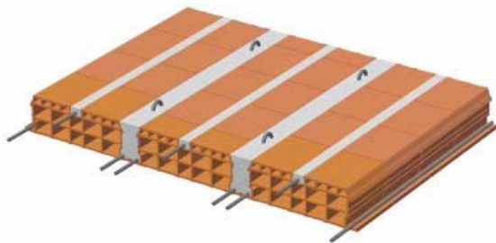
Figura 7.3. Solaio a pannelli prefabbricati
