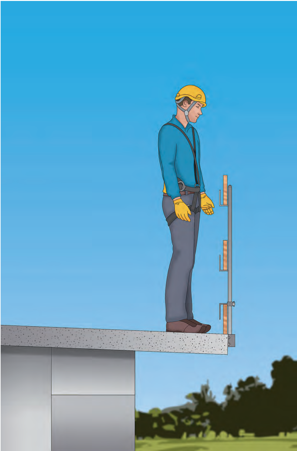
Figura 4 - Parapetti provvisori divisi per classi di utilizzo
