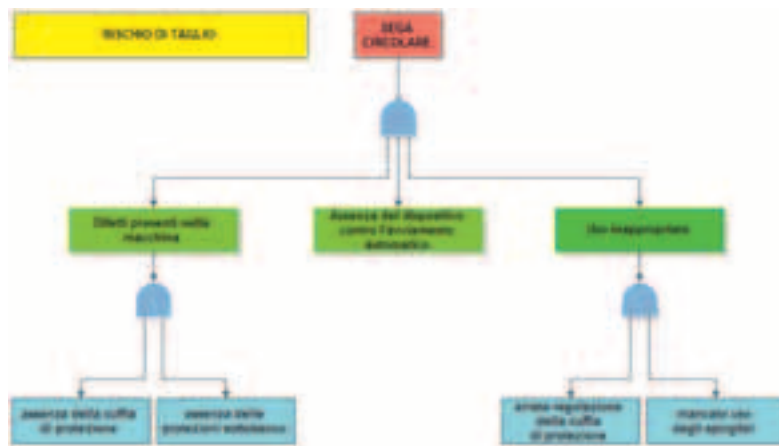
ESEMPIO DI ALBERO DELLE CAUSE - RISCHIO DI TAGLIO: SEGA CIRCOLARE
