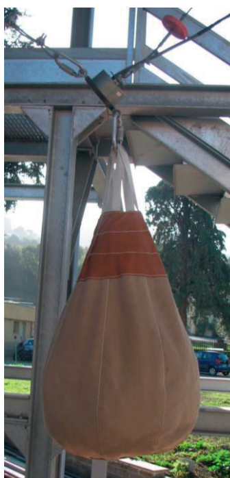
Fig. 6.2-3 Sacco sferoconico con sistema di aggancio/sgancio elettromagnetico - Particolare
