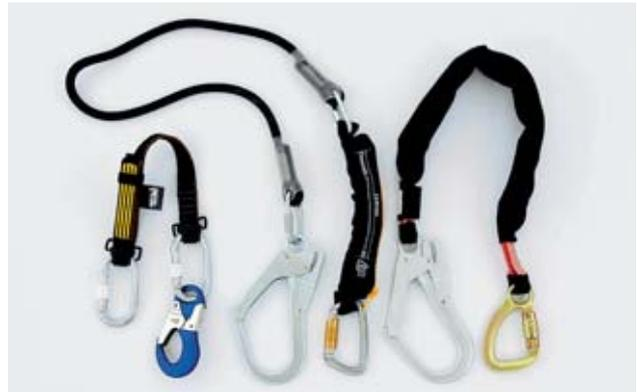
**Figura 10** Nastro a strappo, integrato come assorbitore di energia in un cordino di posizionamento. Con un carico di circa 3 kN (300 kg) il nastro inizia a strapparsi.
