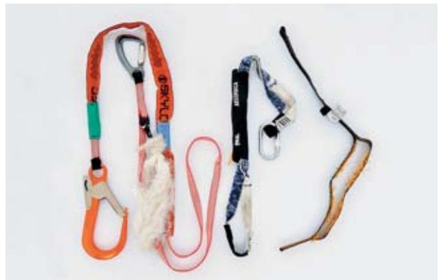
**Figura 11** Esempi di ammortizzatori di caduta strappati. Lo strappo attutisce il contraccolpo.
