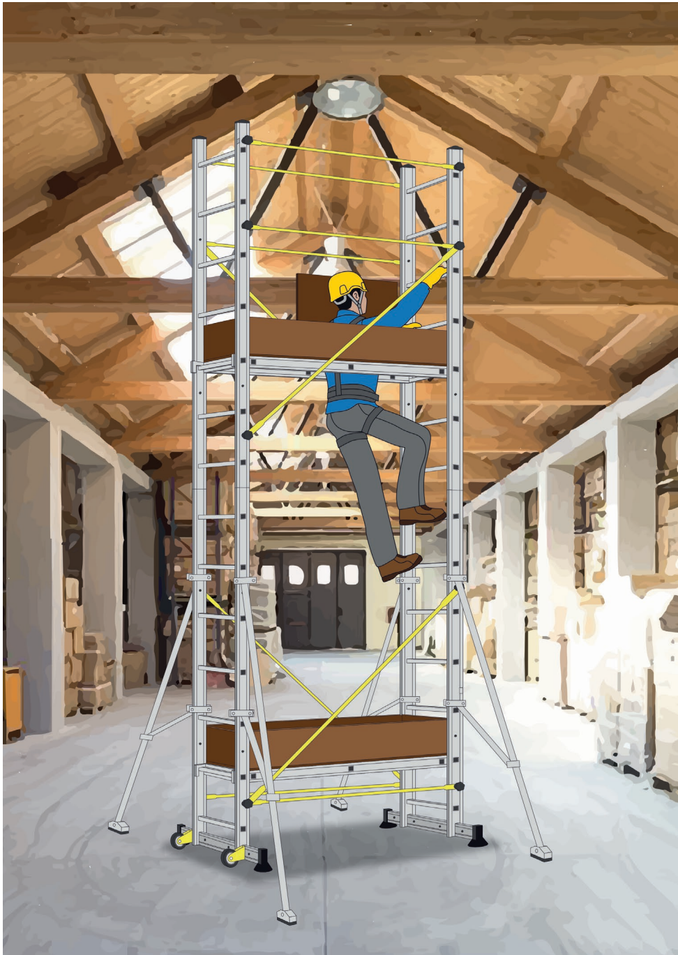
Figura 3 - Piccolo trabattello - Accesso dall'interno
